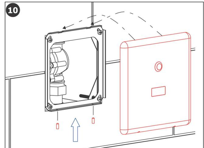
Die Steuerelektronik bzw. deren Stromversorgung darf nicht nach dem Schalter eines Lichtstromkreises angeschlossen werden. Die Steuerelektronik ist immer unter Spannung zu halten.
